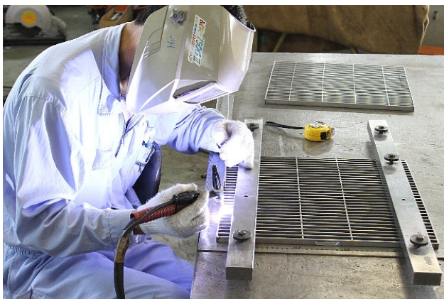
TIG 溶接による溶接作業 ステンレス加工品などの作成
