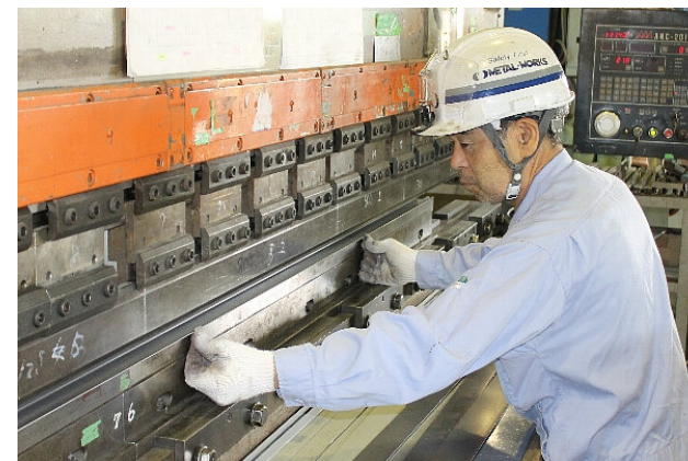
バンダー曲げ加工作業 額縁カーテンボックスなどの作成
